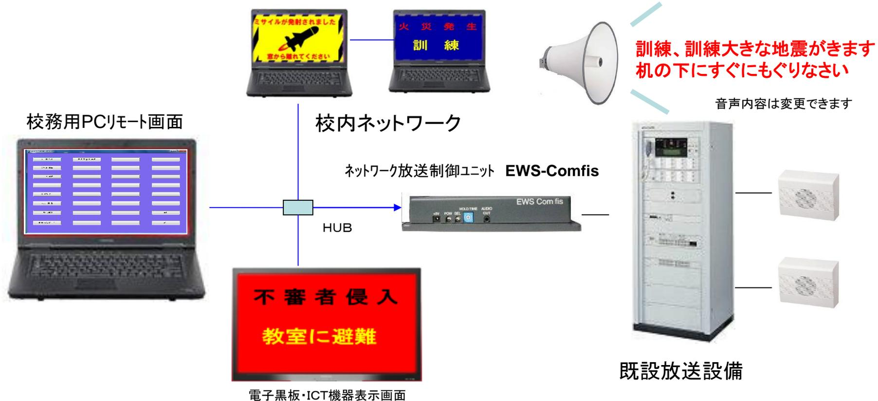
不審者侵入警告放送・暴風雨警報発生時の下校や待機放送などの緊急放送、緊急地震速報訓練放送・火災避難訓練放送・ミサイル避難訓練放送などが既設の校務用PCから校内LANを利活用して放送設備を起動するシステムです。
